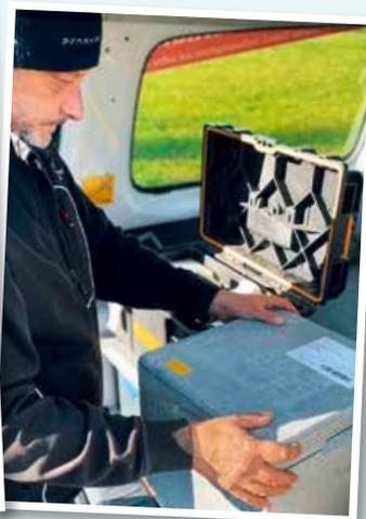
Zum Schluss wird das Wasser abgefüllt, verpackt und ins Labor für eine ausführliche Analyse gesendet.
