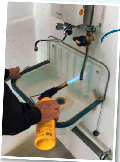
Zuerst wird der Wasserhahn der Probeentnahmestelle mit einem Brenner desinfiziert.
